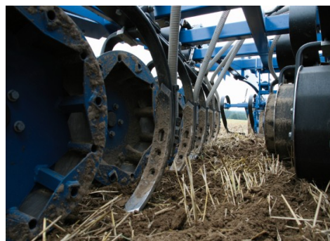
Billede 17. Foran hver såtand er der monteret et dybdestyringshjul. Foto: Köckerling
