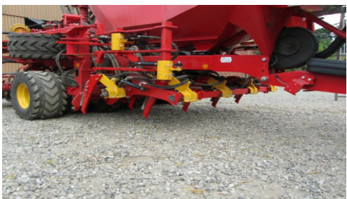
Billede 20. Tænderne løsner I op til 30 cm dybde og arbejder mellem to skiveskær. Foto: Henning Sjørsløv Lyngvig
