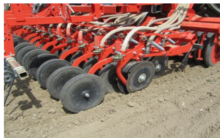
Billede 8. Skiveskær med dybdestyringshjul. Foto: Henning Sjørsløv Lyngvig
